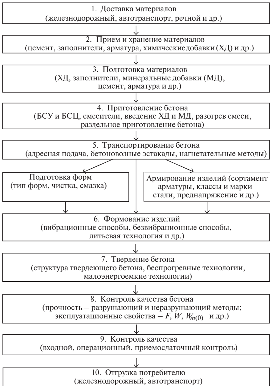
Рис. 1.1. Принципиальная технологическая схема производства бетонных и железобетонных изделий
