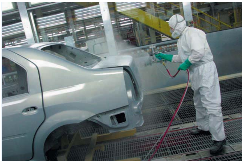
Покраска кузовов на «Автофрамосе»
