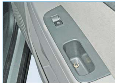
Расположение клавиши выключателя электростеклоподъемника в подлокотнике пассажирской двери
