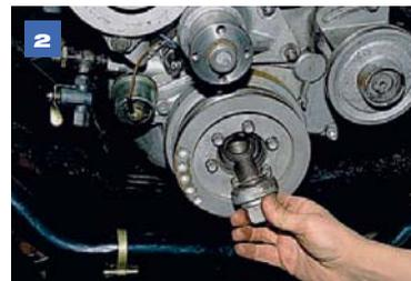
...и вынимаем болт.
