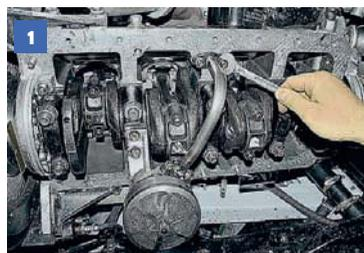
Ключом «на 13» отворачиваем две гайки крепления нагнетательной трубы масляного насоса.
