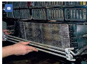
Окончательно снимаем масляный радиатор, вытягивая шланги из лонжеронов рамы.
