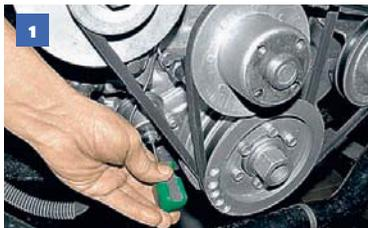
Шлицевой отверткой отворачиваем винт крепления провода к датчику указателя давления масла (для наглядности радиатор и крыльчатка вентилятора сняты).
