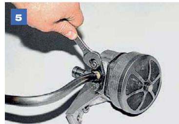
Ключом «на 13» отворачиваем две гайки крепления трубы к насосу.
