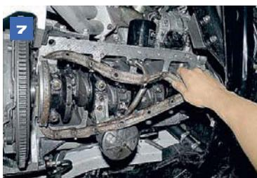
Снимаем прокладку поддона, состоящую из четырех частей.
