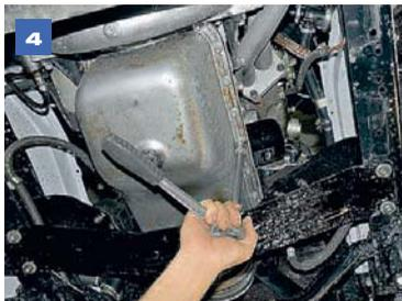
Ключом «на 13» отворачиваем восемнадцать гаек крепления поддона картера. По углам вместо обычных шайб устанавливаются фасонные.
