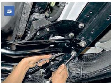
Ключами «на 14» и «17» отворачиваем восемь болтов крепления поперечины.
