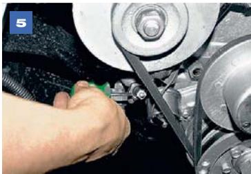
...шлицевой отверткой отворачиваем винт крепления провода к датчику.
