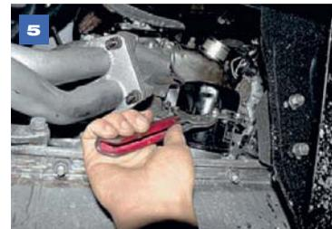
Если сверху отвернуть фильтр затруднительно, отворачиваем его снизу съемником, предварительно сняв брызговик (см. выше).
