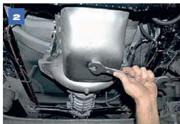
Ключом «на 24» отворачиваем сливную пробку...
