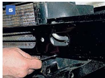
Ключом «на 10» отворачиваем по два болта крепления масляного радиатора снизу...
