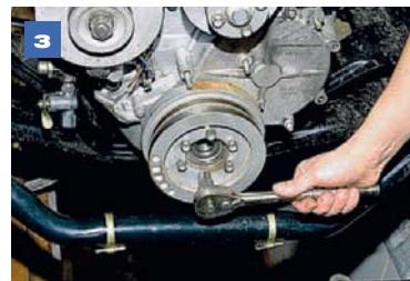
Головкой «на 12» отворачиваем шесть болтов крепления шкива...
