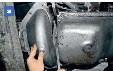
Монтажной лопаткой отжимаем нижнюю часть картера сцепления и снимаем ее.
