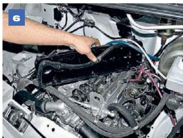
...снимаем крышку с прокладкой.
