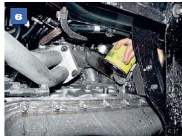
...и руками заворачиваем новый фильтр до упора в блок, после чего доворачиваем его еще на 3/4 оборота.
