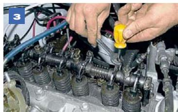
Выставив зазор, удерживаем регулировочный винт, затягиваем контргайку (при этом зазор несколько уменьшится) и вновь проверяем зазор. Регулируем зазоры обоих клапанов первого цилиндра.
