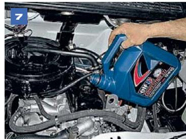
Заливаем 5,8 л свежего моторного масла в заливную горловину.
