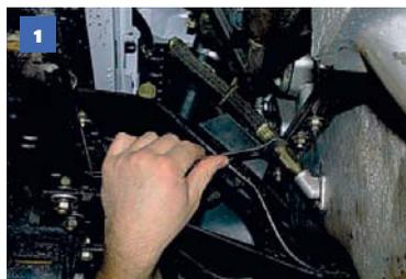
Ключом «на 14» отворачиваем штуцер отводящего шланга масляного радиатора.
