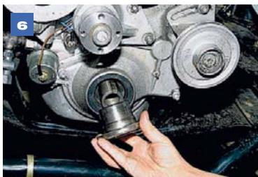
...и снимаем ступицу шкива с коленчатого вала.
