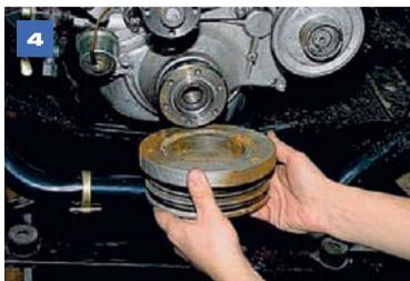
...и снимаем шкив коленчатого вала.
