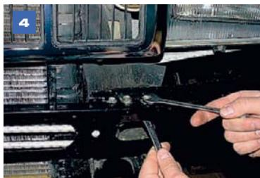
Придерживая гайки ключом «на 13», ключом «на 12» отворачиваем восемь болтов крепления основания бампера к раме.
