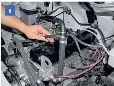
Снимаем малый шланг системы вентиляции картера с патрубком тройника.
