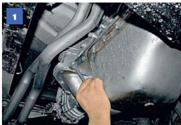
Ключами «на 12» отворачиваем два болта крепления усилителя к картеру сцепления, а ключом «на 14» ослабляем затяжку двух болтов его крепления к блоку цилиндров.
