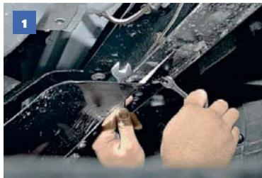
Ключами «на 12» и «на 14» отворачиваем четыре болта с гайками и аналогично ключами «на 10» еще два болта крепления брызговика двигателя к лонжеронам рамы...
