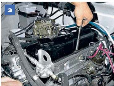
Головкой «на 10» отворачиваем шесть болтов крепления крышки головки блока и снимаем фанонные шайбы, установленные под болтами.
