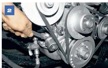
Ключом «на 17» отворачиваем датчик указателя давления масла.
