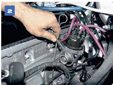
Снимаем шланг с патрубком вакуумного регулятора опережения зажигания.
