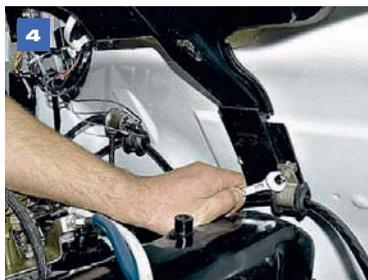
Ключом «на 10» отворачиваем болт кронштейна крепления жгута проводов к панели кузова...
