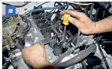
Ключом «на 14» отпускаем контргайку регулировочного винта и на один-два оборота отворачиваем регулировочный винт. Между стержнем клапана и коромыслом вставляем щуп. Заворачиваем регулировочный винт до тех пор, пока щуп не будет двигаться в зазоре с небольшим усилием.
