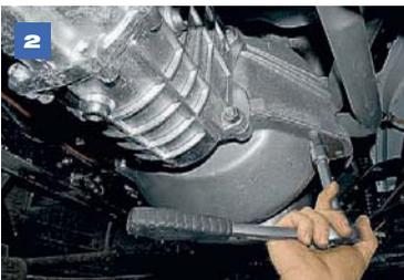
Головкой «на 12» отворачиваем четыре болта нижней части крышки картера сцепления.
