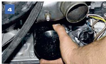
Руками или специальным съемником из подкапотного пространства отворачиваем масляный фильтр.
