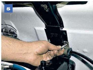
...и снимаем болт со втулкой. Приподняв жгут проводов вверх,...
