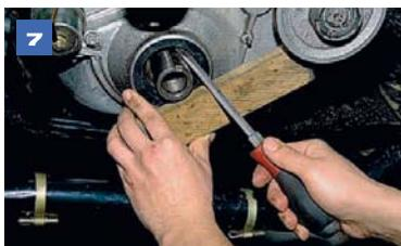
Снимаем манжету, поддев ее отверткой или специальным крючком. При этом отвертку опираем на деревянный брусок, чтобы не повредить кромки посадочного места на крышке.
