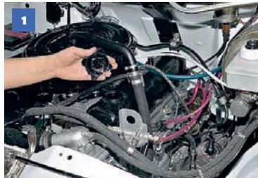
Отворачиваем и снимаем крышку заливной горловины.
