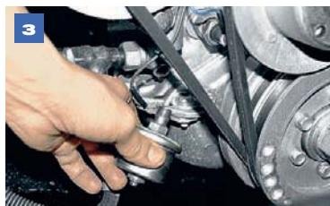
Снимаем датчик, подставив под его гнездо небольшую емкость или подложив ветошь.
