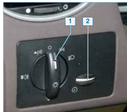
Блок управления наружным освещением на автомобиле с ксеноновым светом фар: 1 — рукоятка управления наружным освещением; 2 — регулятор яркости подсветки комбинации приборов
