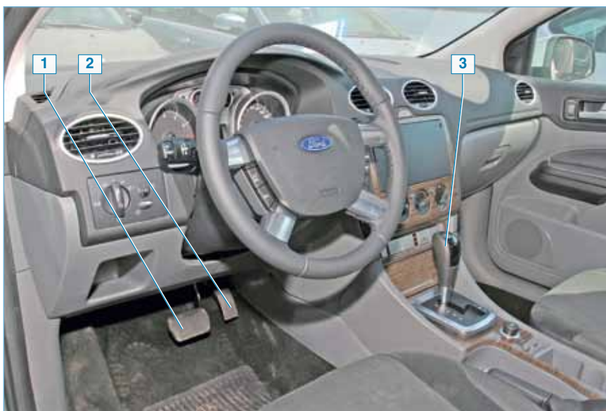
Органы управления автомобилем с автоматической коробкой передач: 1 — педаль тормоза; 2 — педаль «газа»; 3 — рычаг выбора передач
