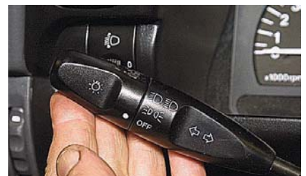
В верхнем положении рычага переключателя включен правый указатель поворота,
