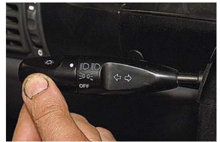
– включены: габаритный свет, освещение номерного знака, подсветка панели приборов, ближний свет фар.
