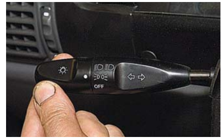
– включены: габаритный свет, освещение номерного знака и подсветка панели приборов;
