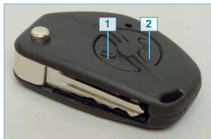
Пульт дистанционного управления: 1 — кнопка дистанционной блокировки всех дверей с одновременной постановкой ре-
