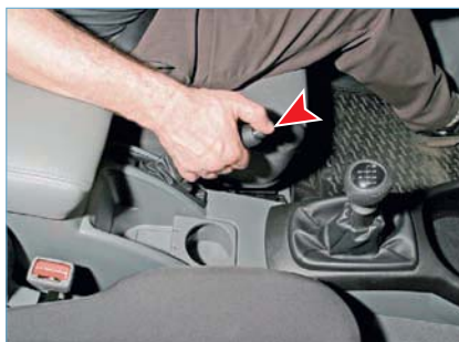
Рычаг стояночного тормоза (кнопка в торце ручки показана стрелкой)
