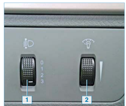
Регулятор световых пучков ближнего света фар 1 и регулятор яркости подсветки комбинации приборов и органов управления 2
