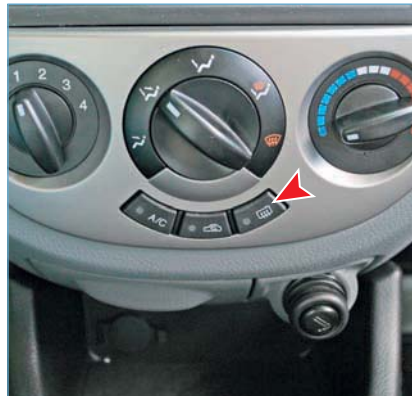
Выключатель обогрева заднего стекла и наружных зеркал (показан стрелкой) в блоке управления системой отопления, вентиляции и кондиционирования (кондиционер с ручным включением)
