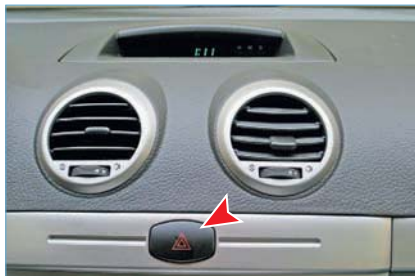
Выключатель аварийной сигнализации (панель автомобиля с кузовами хэтчбек и универсал)
