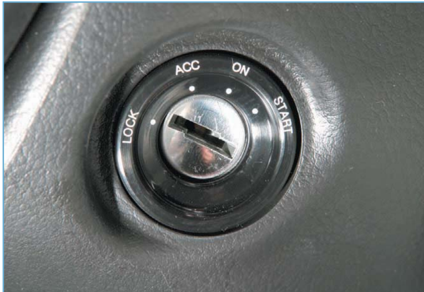
Положения ключа в замке зажигания: LOCK — положение блокировки; ACC — положение, при котором включены потребители; ON — положение зажигания; START — положение включения стартера
