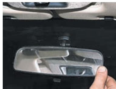
Положение внутрисалонного зеркала регулируем поворотом корпуса зеркала на шарнире.
