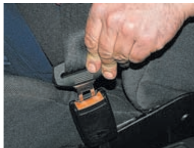
Чтобы пристегнуться, вставляем язычок пряжки ремня в гнездо замка до щелчка.
