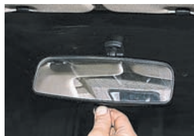
Если фары движущихся сзади автомобилей через зеркало ослепляют водителя, можно изменить угол наклона зеркала нажатием рычажка в нижней части корпуса.
