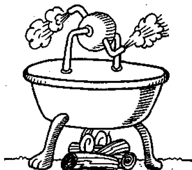
Рис. 1.1. «Ветряной шар» Герона
