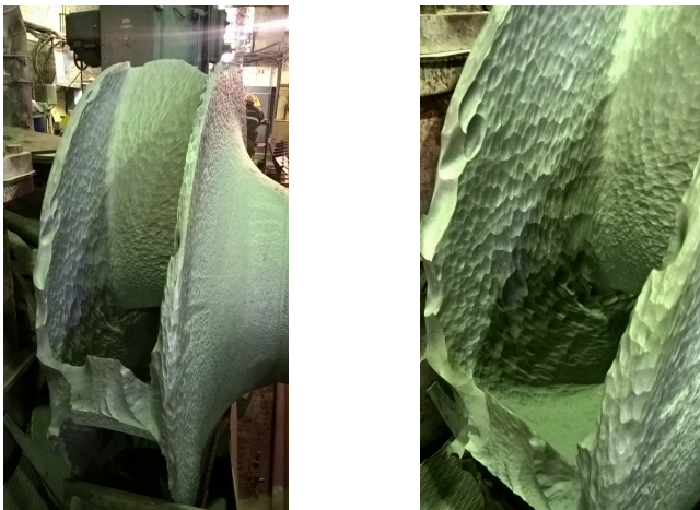
Рис. 1.3. Износ рабочего колеса насоса под воздействием абразивной пульпы
