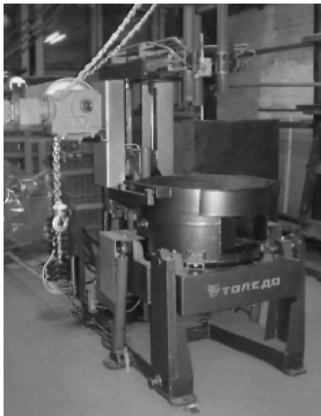
Рис. 1.1. Дуговая печь постоянного тока вместимостью 250 кг
