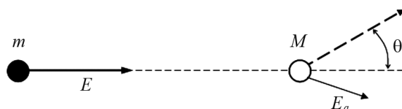
Рис. 2.1. Схема упругого взаимодействия быстрой частицы массы m с атомом кристалла-мишени массы M
