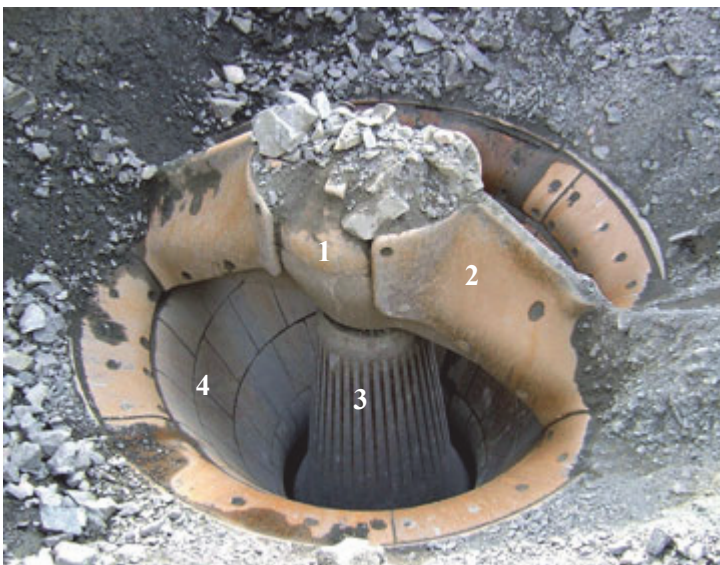
Рис. 1.11. Конусная дробилка крупного дробления.
