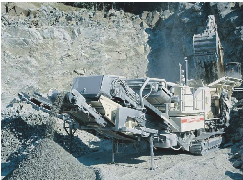
Рис. 1.6. Передвижная дробильно-сортировочная установка «Нордберг» компании «Метсо Минералз»
