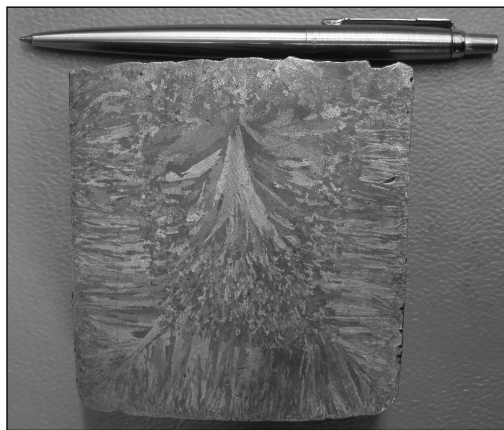
Рис. 1.2. Макроструктура слитка меди
