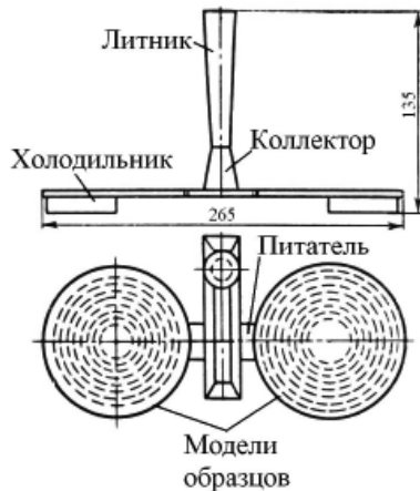
Рис. 1.1. Схема кольцевой полукокильной пробы «ВИАМ» [15, 16]
