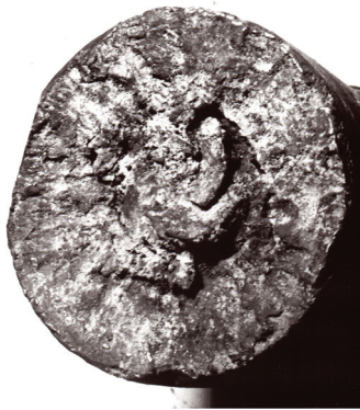
Рис. 1.2. Разрушение вагонной колесной оси в результате эффекта Ребиндера с латунной армировкой подшипника скольжения после задира
