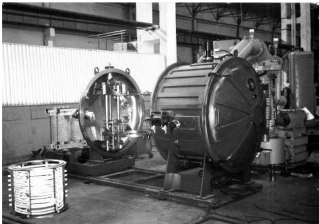
Рис. 1.1. Вакуумная плавильная установка ВПДС-1
