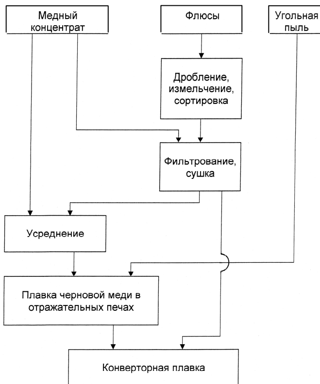
Рис. 1.2. Схема технологического процесса подготовки шихтовых материалов на медеплавильном заводе
