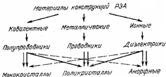
Рис. 1.1. Классификация материалов электронной техники по составу, структуре и электропроводности
