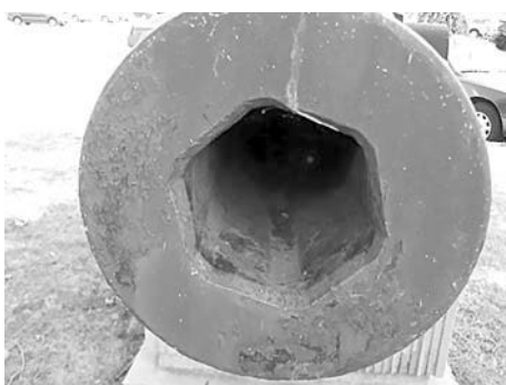
70-фнт. (160-мм) дульнозарядное орудие Уитворта в музее Вашингтонской военной верфи, США. Справа хорошо виден шестигранный канал ствола
