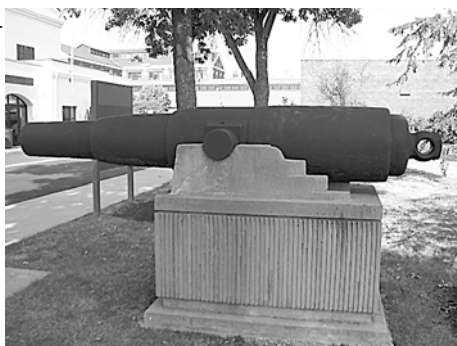
70-фнт. (160-мм) дульнозарядное орудие Уитворта в музее Вашингтонской военной верфи, США. Справа хорошо виден шестигранный канал ствола
