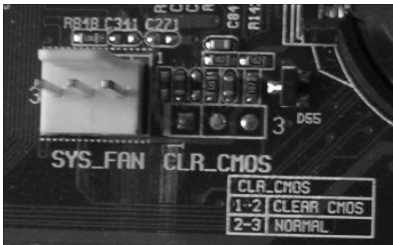
Рис. 2.2. Перемычка для сброса настроек может и отсутствовать
