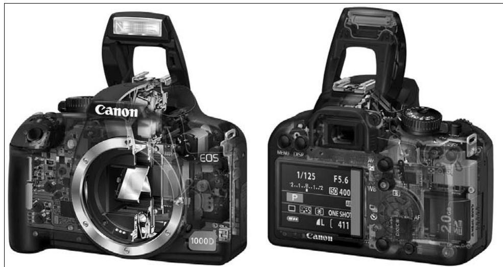
Рис. 1.6. Внутреннее устройство цифровой SLR-камеры
