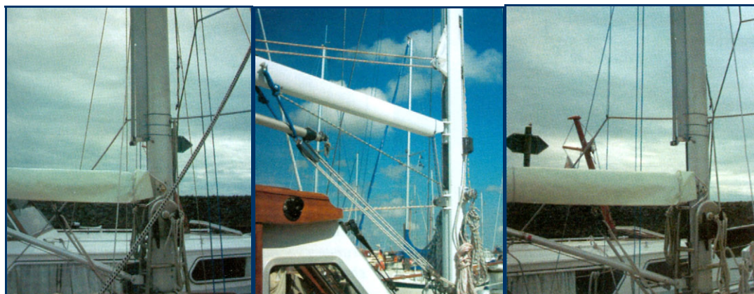
Система рифления в мачту, которая была добавлена к оригинальной мачте. Такие системы дешевле, чем покупка новой мачты с закруткой грота, однако они ведут к увеличению веса и парусности рангоута.
