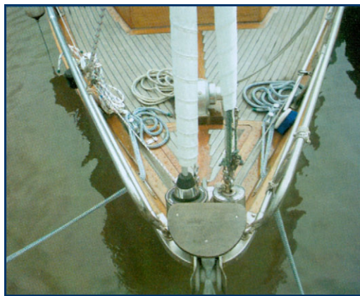
Двойной закручивающийся стаксель: роскошь для круизных лодок.
