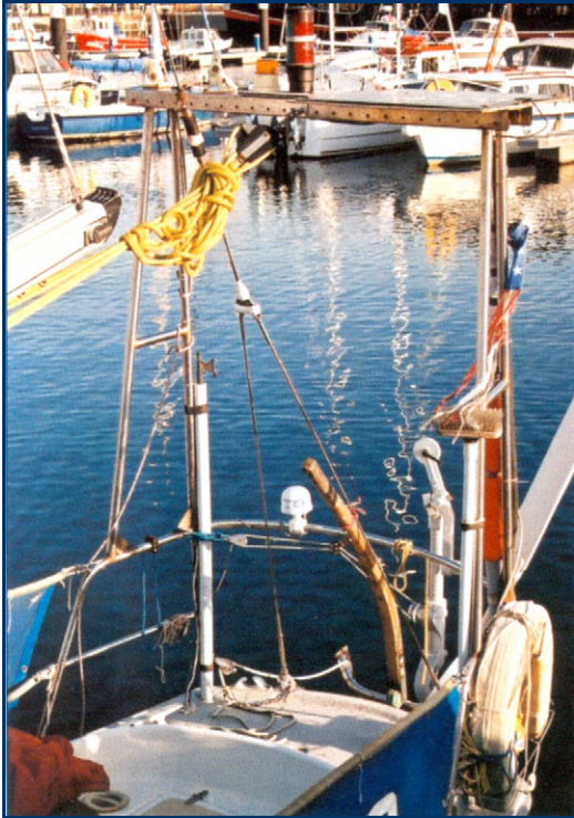
Кормовая «стойка ворот» для установки оборудования.
