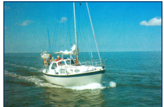
Яхты с мотором (мотосейлеры) достаточно широко, чтобы сделать круизную яхту весьма комфортабельной, при условии, что приемлем их относительно слабый ход против ветра.
