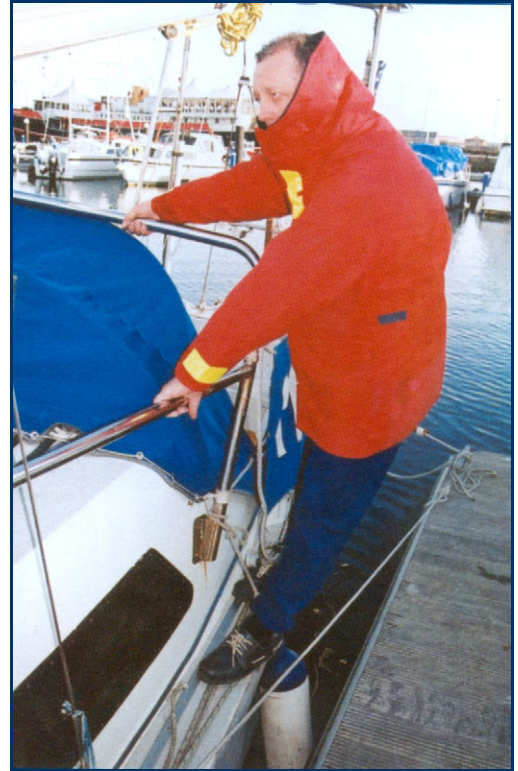
Трубчатый каркас вокруг ветрового обтекателя часто используется в качестве перил при передвижении по палубе для работы с парусами. Фитинги большинства таких перил недостаточно надежны, чтобы смело держаться за них руками, но это довольно хорошее и безопасное дополнение.
