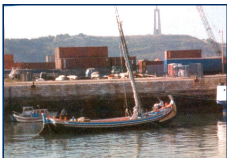
Латинский парус: его можно увидеть только в Лас-Пальмасе на Канарских островах, где он участвует в гонках с многочисленным экипажем. Смена галса — это усилия команды по переносу реи вокруг мачты.
