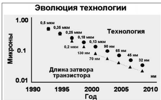
Рис. 1.1. Эволюция технологических процессов компании Intel
