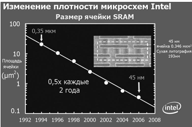
Рис. 1.8. Изменение плотности микросхем
