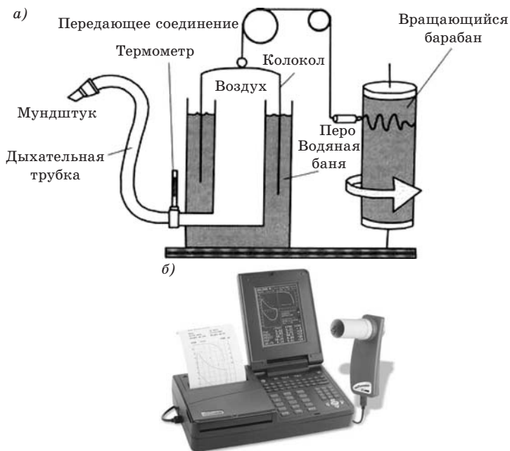
Рис. 2. Схема работы водяного спирографа закрытого типа (а); современный диагностический спирограф Spirolab (MIR, Италия) с оксиметрической приставкой (б)
