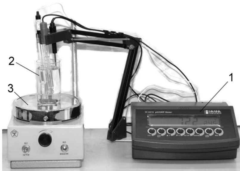
Рис. 1.1. Внешний вид экспериментального оборудования: 1 — рН-метр; 2 — измерительная ячейка; 3 — магнитная мешалка
