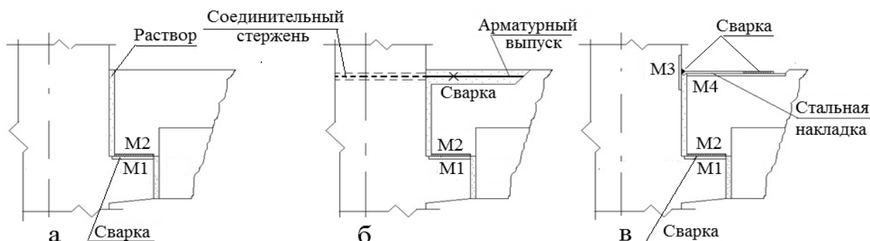
Рис. 1.4. Схемы конструктивного решения стыка ригеля и колонны: а — шарнирный стык (сварка закладной детали консоли колонны M1 и закладной детали ригеля M2); б — жесткий стык (сварка арматурных выпусков двух ригелей с использованием соединительного стержня, пропускаемого через отверстие в колонне; сварка закладных деталей M1 и M2); в — полужесткий стык (сварка закладных деталей M4, M3 в верхней зоне ригеля с использованием стальной накладки; сварка закладных деталей M1 и M2)
