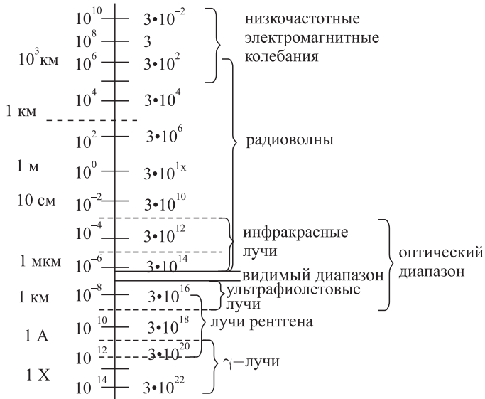
Рис. 1. Шкала электромагнитных волн. Слева — шкала длин волн электромагнитного излучения в метрах, справа — шкала частот в герцах
