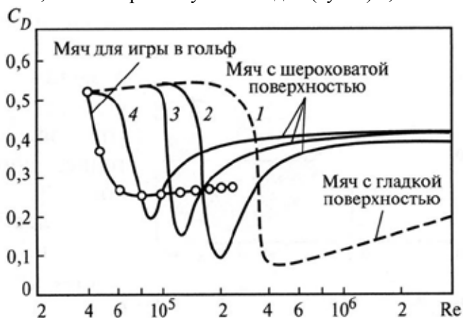
Рис.1.4. Зависимость коэффициента сопротивления для шаров с гладкой и шероховатой поверхностью и олуненного мяча для игры в гольф: \circ — мяч с лунками h/d = 0,009 ; 2, 3, 4 — шары с относительной шероховатостью h/d 0,0015, 0,005 и 0,0125 соответственно h — размер шероховатости или глубина лунки, d — диаметр шара [4]
