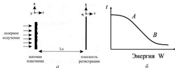
Рис. 1.6. Схема регистрации спекл-картины в опытах Бурча и Токарского (а) и кривая почернения фотопластинки под действием экспозиции (б) [1]
