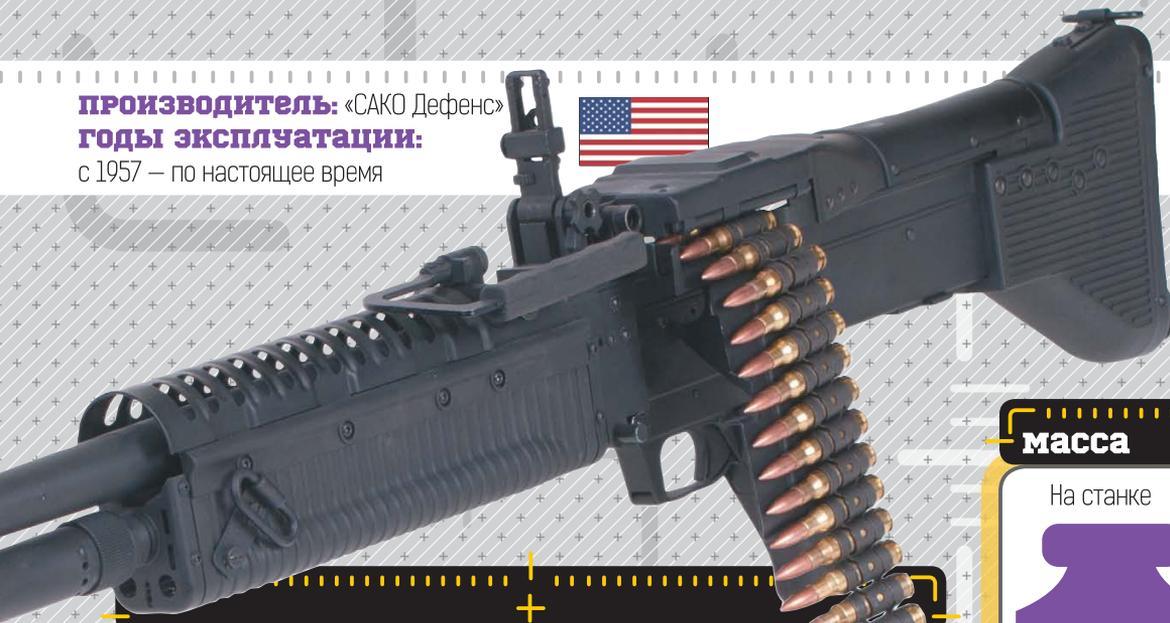
Пулемет М60 представляет собой автоматическое оружие с воздушным охлаждением быстросменного ствола. Комплектуется складной двуногой сошкой на стволе, но может устанавливаться и на пехотный станок-треногу. Откидные сошки предохраняют руки бойцов от ожогов, а большая ствольная накладка помогает в переноске оружия. В качестве вспомогательного инструмента для разборки пулемета мог использоваться обычный патрон.
