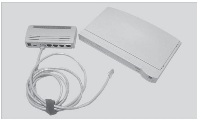
Рис. 1.5. Концентратор – связующий центр сети
