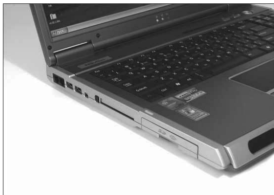
Рис. 1.3. Слот устройства чтения карт памяти, USB-порты на боковой панели ноутбука
