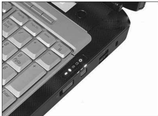
Рис. 1.2. Индикаторы активности жесткого диска, аккумулятора, активности беспроводных интерфейсов
