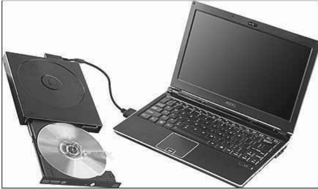
Рис. 1.8. Подключение внешнего оптического дисковода
