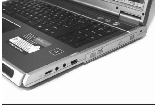
Рис. 1.4. Оптический привод и разъемы аудио на боковой панели
