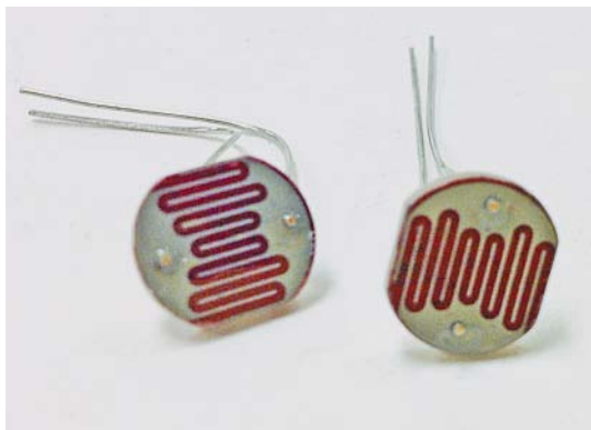
Рис. 1.18. Датчики передают Arduino информацию о степени освещенности
