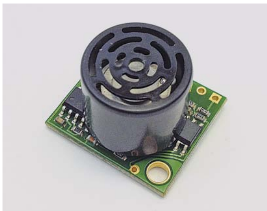
Рис. 1.19. Ультразвуковой датчик работает как радар
