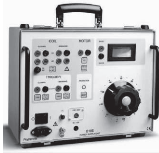
Рис. 1.2. Внешний вид устройства типа V10E для проверки минимального напряжения срабатывания приводов высоковольтных выключателей
