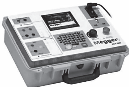
Рис. 1.8. Устройство типа MCT1600 фирмы Megger для проверки трансформаторов тока
