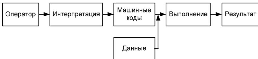
Рис. 1.1. Схема работы в режиме интерпретации
