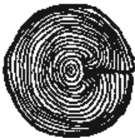
Рис. 8. Прорость – повреждение клетчатки древесины
