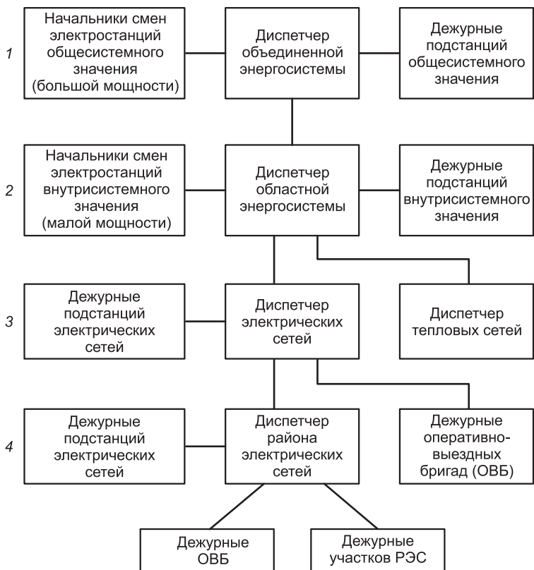
Рис. 1.1. Структура четырехступенчатой системы диспетчерского управления: 1–4 – уровни управления
