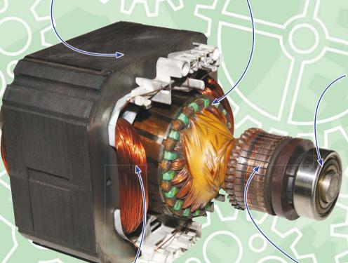
Ротор. Во время работы электродвигателя совершает вращательные движения. При включении тока электромагниты ротора и статора имеют одинаковый полюс и поэтому стремятся оттолкнуться друг от друга. Происходит поворот ротора на небольшой угол, а так как в этот момент в магнитное поле статора попадает следующая часть обмотки ротора, то это заставляет ротор постоянно вращаться, так как на место «вытолкнутых» частей обмотки все время подходят новые
