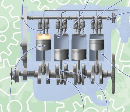
Поршень. Подвижная деталь, которая находится внутри цилиндра и перемещается вдоль его оси
