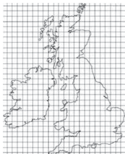
Рис. 2. 2. 1. Пример измерения площади Великобритании с помощью палетки
