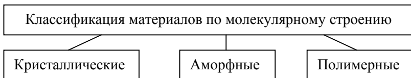
Рис. 1.5. Классификация материалов по молекулярному строению
