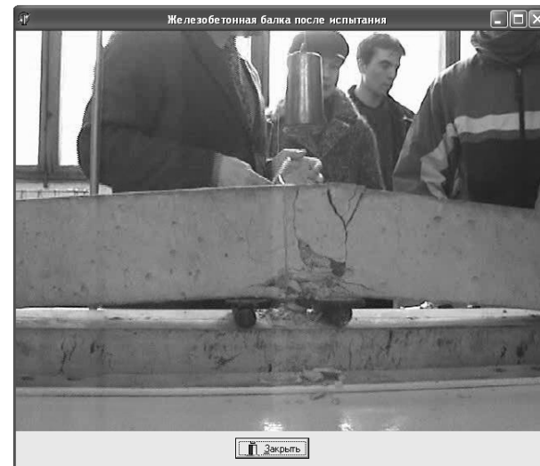
Рис. 1.7. Разрушение железобетонной балки по нормальному сечению
