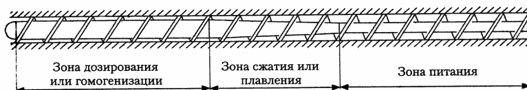
Рисунок 1.1 — Разделение шнека на три стадии технологического процесса
