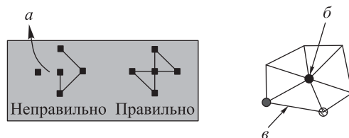
Рис. 1.14. Вырождение ячеек в STL-файле: a — геометрическое вырождение — вырожденный треугольник с тремя различными вершинами; б — топологическое вырождение — вырожденный треугольник с тремя совпадающими вершинами — точка ; в — топологическое вырождение — вырожденный треугольник с двумя совпадающими вершинами — линия
