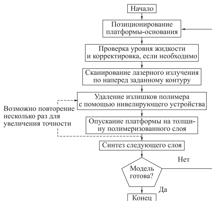
Рис. 1.25. Блок-схема процесса лазерной стереолитографии
