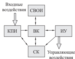
Рис. 1.2. Обобщенная структура комплексов ориентации и навигации
