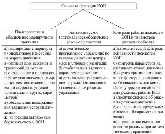
Рис. 1.1. Основные функции комплексов ориентации и навигации
