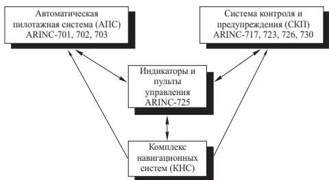
Рис. 1.8. Обобщенная структура типового пилотажно-навигационного комплекса
