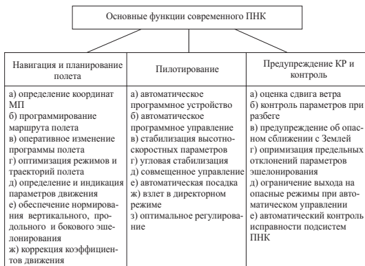
Рис. 1.7. Основные функции пилотно-навигационного комплекса
