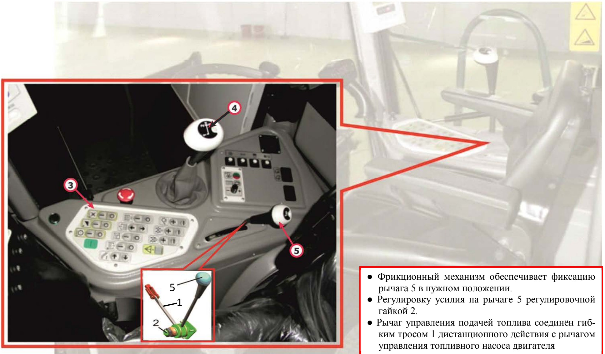
Рисунок 2.4 – Рычаги управления коробкой передач и подачей топлива:
