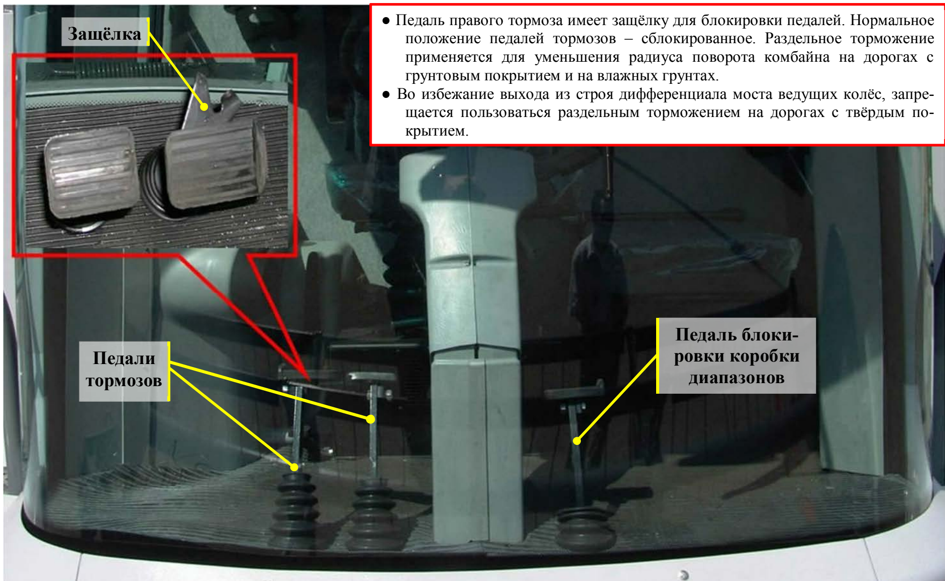
Рисунок 2.11 – Педали тормозов и блокировки коробки диапазонов
