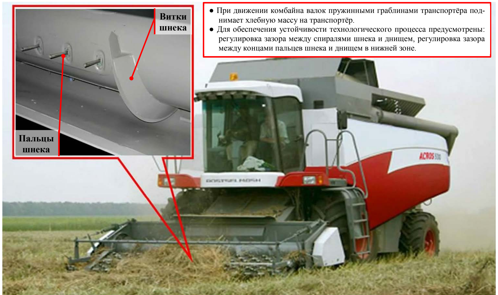
Рисунок 1.7 – Порядок работы платформы-подборщика
