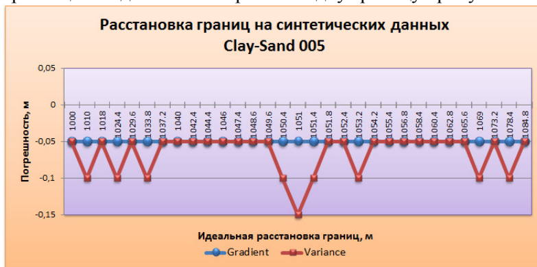
Рис. 3.1.2. Сравнение идеальных границ с границами, расставленными градиентным и статистическим методами на данных Clay-Sand 005.
