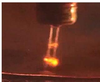
Рис. 1. Фотография ЭР между струйным электролитическим анодом и медным катодом при  $t = 0,04$  с,  $P = 10^5$  Па,  $G = 4$  г/с,  $v = 0,5$  м/с,  $U = 485$  В,  $l_c = 10$  мм и  $d_c = 3$  мм. Электролит – насыщенный раствор NaCl в технической воде
