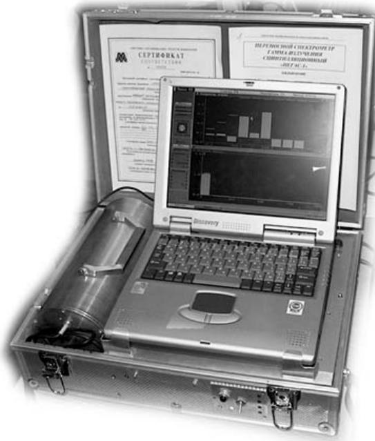
Рис. ИС.10. Гамма-спектрометр «Пегас»
