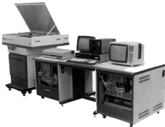
Рис. ИС.16. Общий вид мессбауэровского спектрометра СМ-2201 совместной разработки УПИ (УГТУ-УПИ) и ИАП АН СССР (РАН)
