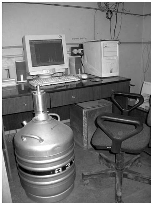
Рис. ИС.13. Стационарный прибор для определения химического состава растворов редких земель
