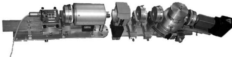
Рис. ИС.21. Мессбауэровский спектрометр CM-1101TER
