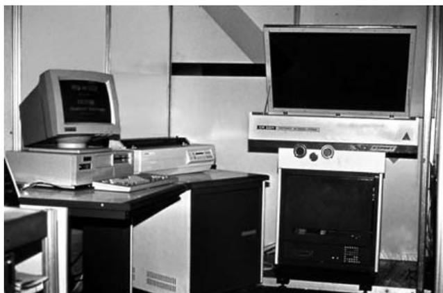
Рис. ИС.19. Мессбауэровский спектрометр СМ-2201
